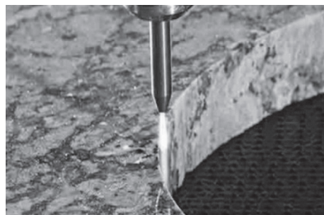
石材とタイル類の切断
