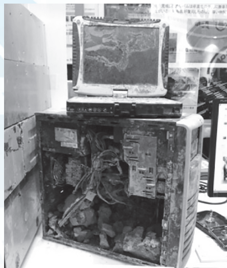
津波被害によるパソコン
