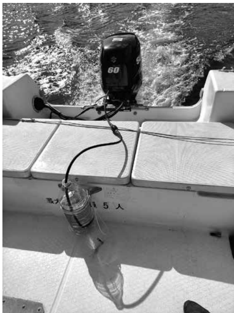
図1. 消費燃料実測のために、燃料タンクをペットボトルに付け替えて実験実施。
