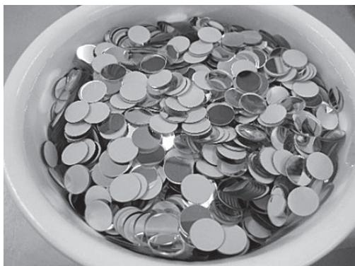
芯取機で面取りされた鏡（ミラー）の乾燥を防ぐための工程
